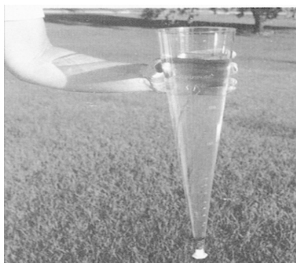
รูปที่ 11 เครื่องวัดปริมาณทรายแบบกรวยอิมฮอฟ (Driscoll, 1987)
