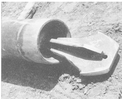
รูปที่ 2 ลิ้นกันกลับที่ปลายกระบอทดักน้ำ (Driscoll, 1987)
