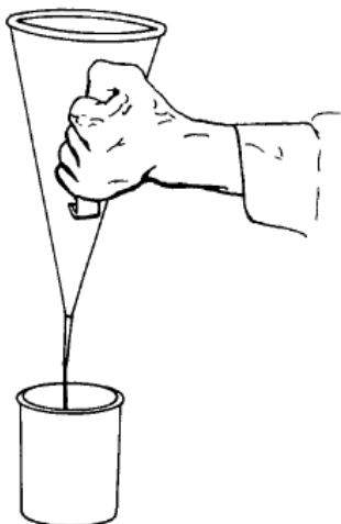
รูปที่ 5 แสดงการตรวจวัดความหนืดของน้ำโคลน (NGWA, 2006)
