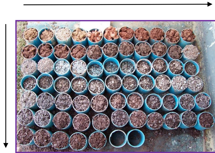
รูปที่ 5-26 แสดงลักษณะการวางตัวอย่างแบบเศษดินหินจากหลุมเจาะอย่างถูกต้อง โดยการวางเรียงจากซ้ายไปขวา และจากบนลงล่าง
