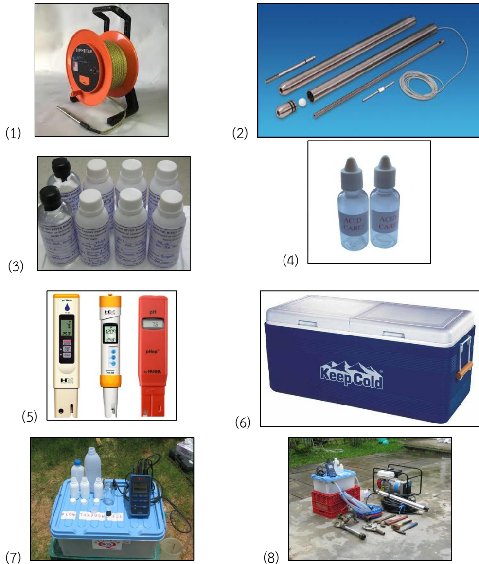
รูปที่ 2-34 แสดงตัวอย่างของอุปกรณ์สำรวจด้านอุทกธรณีวิทยา (1) เครื่องวัดระดับน้ำ (electrical dip meter) (2) กระบอกเก็บตัวอย่างน้ำ (bailer) (3) ขวดเก็บตัวอย่างน้ำ (sample bottles) (4) กรดสำหรับรักษาสภาพตัวอย่างน้ำ (nitric acid for preserve water) (5) pocket test kits (6) กล่องใส่น้ำแข็ง (ice box) (7) flow cell (กล่องพลาสติกไฟฟ้า) (8) อุปกรณ์อื่น ๆ ที่จำเป็น ได้แก่ เครื่องสูบลมแบบจุ่มได้น้ำ เครื่องปั่นไฟฟ้า ค้อน และประแจ (ภาพประกอบบางส่วนจาก Wikipedia)
