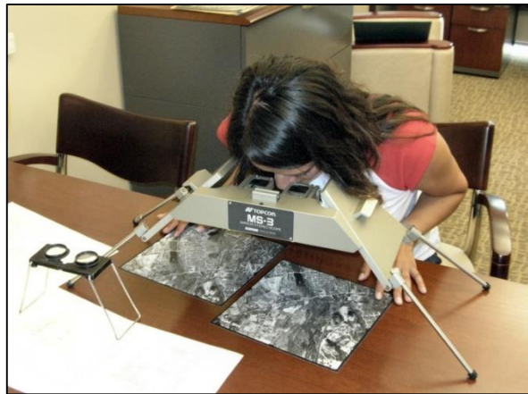
รูปที่ 2-14 แสดงการใช้กล้อง Mirror Stereoscope ในการแปลความหมายภาพถ่ายทางอากาศ 2 ภาพที่มีพื้นที่ซ้อนทับกันประมาณ 60 % ซึ่งจะทำให้มองเห็นภาพในส่วนที่ซ้อนทับกันเป็น 3 มิติ ทำให้รู้ความสูง-ต่ำของวัตถุที่อยู่บนภาพถ่ายทางอากาศได้
