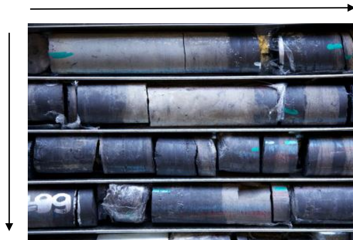
รูปที่ 5-27 แสดงลักษณะการวางตัวอย่างหินแบบแท่งหินจากหลุมเจาะอย่างถูกต้อง โดยการวางเรียงจากซ้ายไปขวา และจากบนลงล่าง แกวบนสุดจะอยู่ติดกับบานพับของกล่องใส่ตัวอย่างแท่งหินที่มีฝาปิดเสมอ
