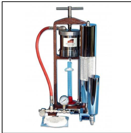
รูปที่ 4-16 แสดงเครื่องมือที่ใช้ตรวจสอบคุณสมบัติด้านการซึมและการเกิดผนังซึมซาบ (filtration and filter cake) ของน้ำโคลน
