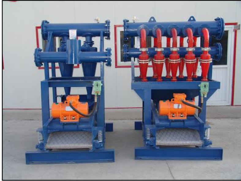
รูปที่ 4-17 แสดงเครื่องกำจัดทราย (desander ซ้าย) และเครื่องกำจัดทรายแป้ง (desilter ขวา) ที่ใช้ในการกำจัดตะกอนทั้ง 2 ขนาดตามลำดับ
