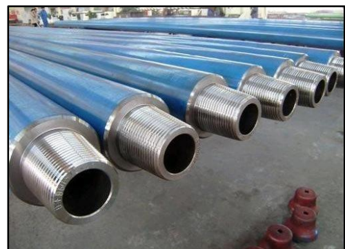
รูปที่ 4-6 แสดงลักษณะทั่วไปของท่อถ่วง (drill collar) ซึ่งมีลักษณะเกลียวเหมือนกับก้านเจาะ
