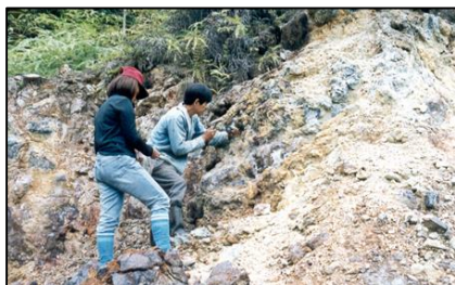
รูปที่ 3-1 แสดงการสำรวจธรณีวิทยาภาคสนามได้แก่การวัดการวางตัวของหิน (attitudes of plane) การเก็บตัวอย่างหิน (rock sampling) และการบันทึกภาพสิ่งที่เห็นในภาคสนาม (picture taking)
