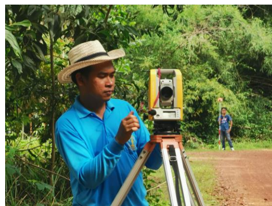
รูปที่ 2-1 การสำรวจทางราบและทางตั้ง ด้วยกล้อง Total Station
