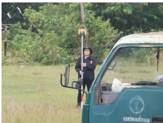
รูปที่ 2-1 การสำรวจทางราบและทางตั้ง ด้วยกล้อง Total Station
