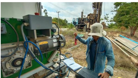
รูปที่ 4-22 แสดงการหยั่งธรณีฟิสิกส์หลุมเจาะเพื่อหาคุณสมบัติทางกายภาพของชั้นดินหรือหิน
