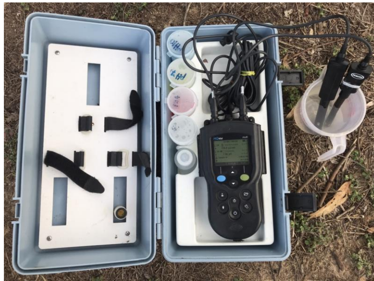
รูปที่ 3-20 การตรวจวิเคราะห์คุณภาพน้ำบาดาลทางเคมีเบื้องต้นตรงบริเวณ ณ ปากบ่อ
