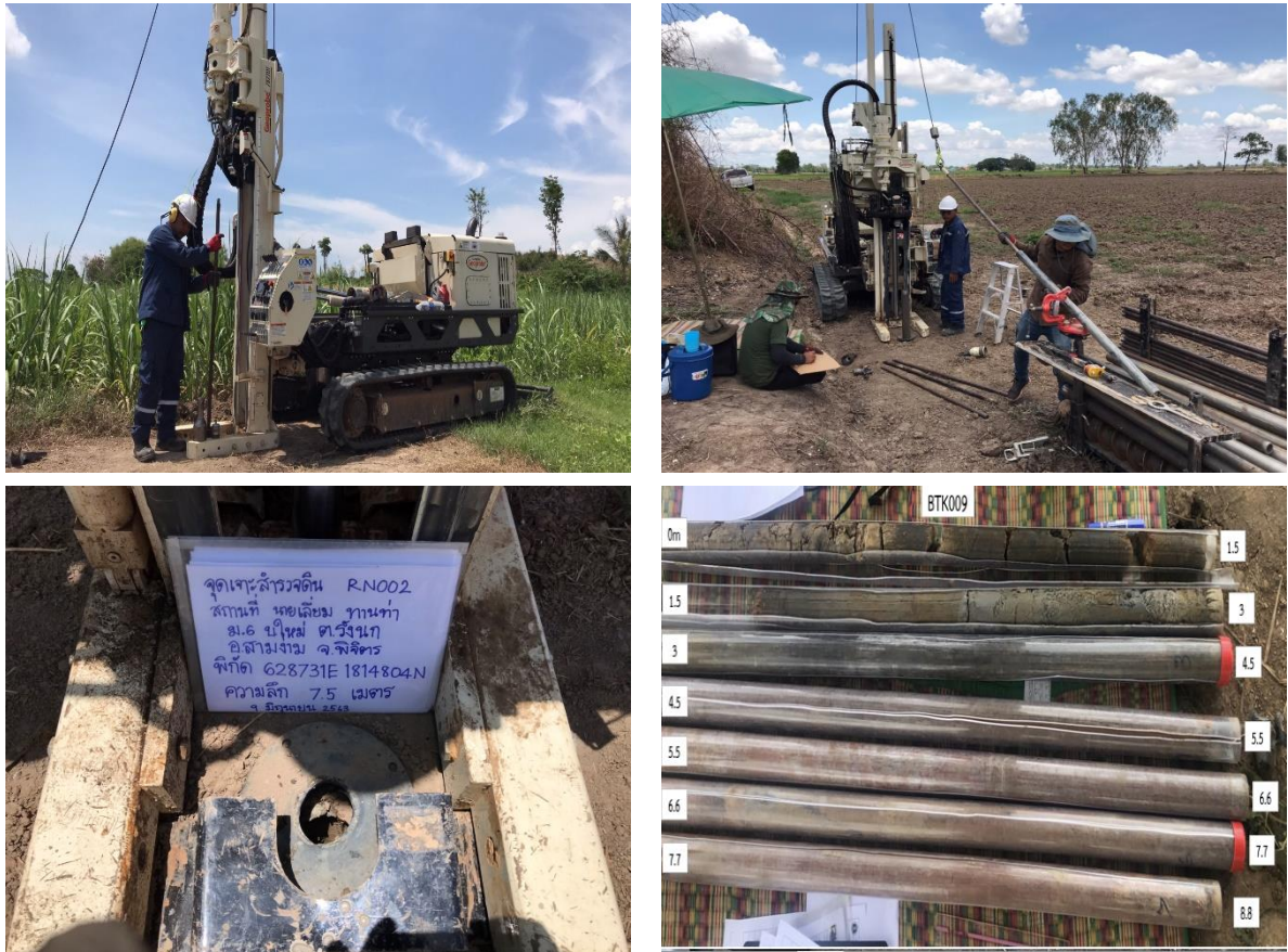
รูปที่ 3-1 ขั้นตอนการดำเนินการเจาะสำรวจชั้นน้ำบาดาลระดับต้นโดยประยุกต์ใช้เครื่องมือเจาะสำรวจ MIP
