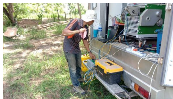
รูปที่ 4-22 แสดงการหยั่งธรณีฟิสิกส์หลุมเจาะเพื่อหาคุณสมบัติทางกายภาพของชั้นดินหรือหิน
