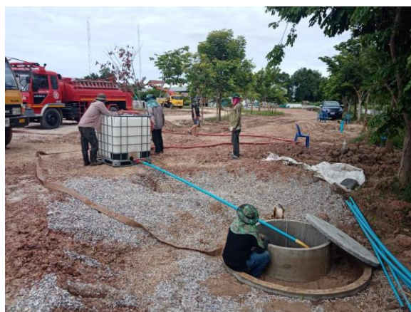
รูปที่ 4-14 การทดสอบเติมน้ำแบบต่อเนื่อง
