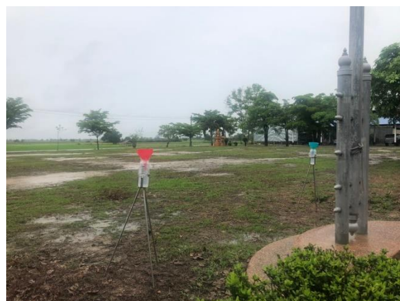
รูปที่ 3-22 การเก็บตัวอย่างน้ำเพื่อวิเคราะห์คุณภาพน้ำฝนแบบสมบูรณ์
