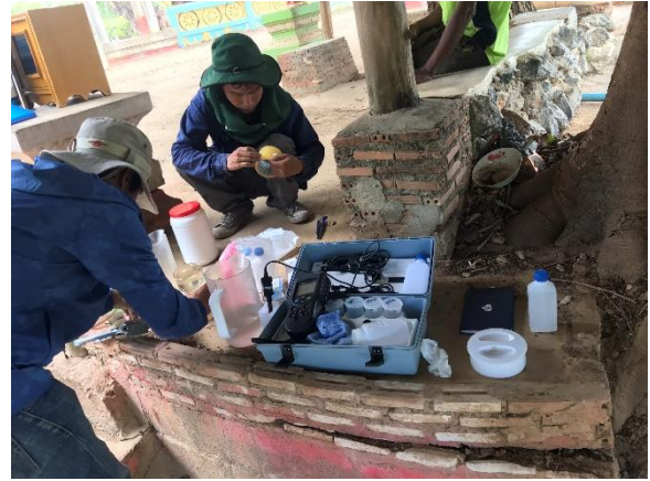
รูปที่ 3-19 การเก็บตัวอย่างน้ำเพื่อวิเคราะห์คุณภาพน้ำแบบสมบูรณ์และคุณลักษณะที่เป็นพิษ
