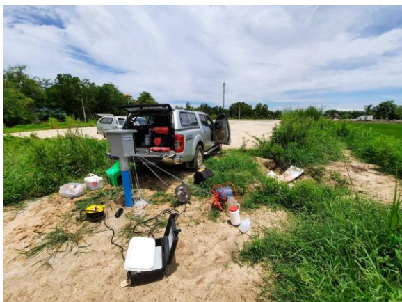
รูปที่ 4-29 การเก็บตัวอย่างน้ำเพื่อวิเคราะห์คุณภาพน้ำแบบสมบูรณ์ และคุณลักษณะที่เป็นพิษจากบ่อสังเกตการณ์ของโครงการฯ
