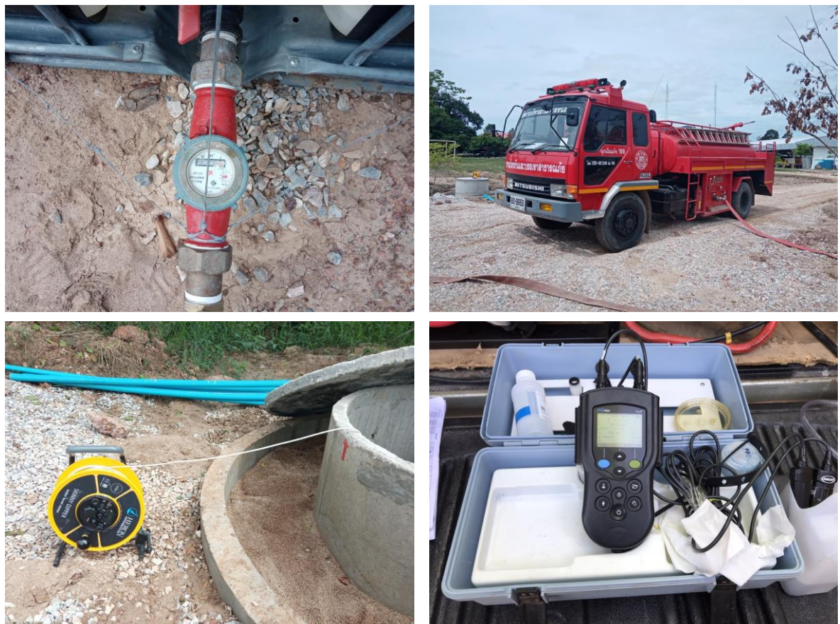
รูปที่ 4-13 อุปกรณ์ที่ใช้ในการทดสอบระบบเติมน้ำ
