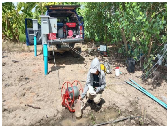
รูปที่ 4-29 การเก็บตัวอย่างน้ำเพื่อวิเคราะห์คุณภาพน้ำแบบสมบูรณ์ และคุณลักษณะที่เป็นพิษจากบ่อสังเกตการณ์ของโครงการฯ
