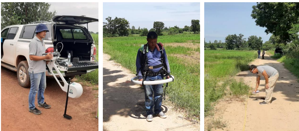
รูปที่ 3-13 (ซ้าย) ลักษณะของกล่องรับสัญญาณคลื่นแม่เหล็กไฟฟ้าที่อยู่ด้านล่างและกล่องควบคุมที่อยู่ด้านบน (กลาง) ห่วงวงกลมที่ใช้ปล่อยสัญญาณแม่เหล็กไฟฟ้า มีลักษณะการวางขนานกับพื้นโลก (ขวา) การทำสัญลักษณ์บอกระยะทาง เพื่อความสะดวกในการย้ายตัวรับและตัวปล่อยสัญญาณไปยังจุดสำรวจที่อยู่ถัดไป
