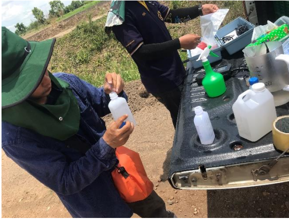
รูปที่ 3-19 การเก็บตัวอย่างน้ำเพื่อวิเคราะห์คุณภาพน้ำแบบสมบูรณ์และคุณลักษณะที่เป็นพิษ
