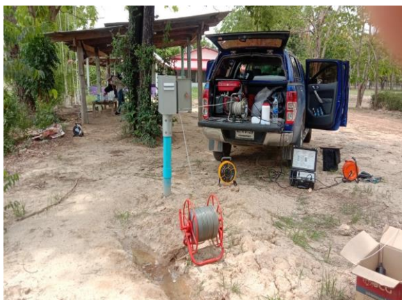
รูปที่ 4-31 การเก็บตัวอย่างน้ำและวิเคราะห์สารเคมีกำจัดศัตรูพืชในแหล่งน้ำบาดาล จากบ่อสังเกตการณ์ของโครงการฯ
