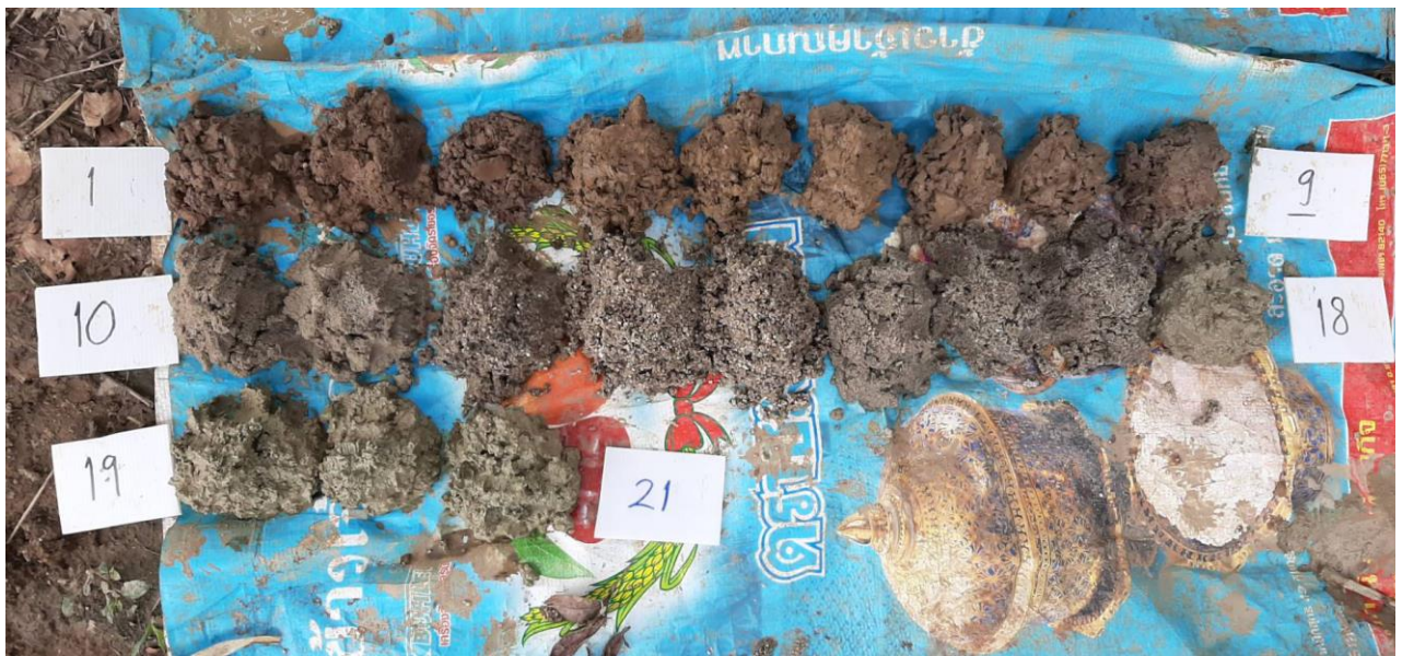
รูปที่ 4-19 ตัวอย่างชั้นดินชั้นหิน ที่ได้จากหลุมเจาะ ทุกความลึก 1 เมตร
