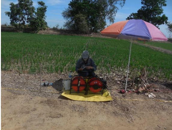
รูปที่ 3-6 การสำรวจธรณีฟิสิกส์โดยวิธีวัดค่าความต้านทานไฟฟ้าแบบหยั่งลึก
