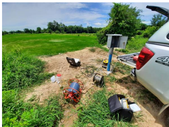
รูปที่ 4-31 การเก็บตัวอย่างน้ำและวิเคราะห์สารเคมีกำจัดศัตรูพืชในแหล่งน้ำบาดาล จากบ่อสังเกตการณ์ของโครงการฯ
