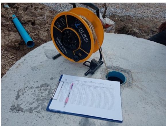
รูปที่ 4-14 การทดสอบเติมน้ำแบบต่อเนื่อง
