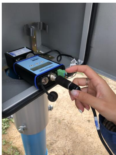
รูปที่ 4-32 แสดงการติดตั้งเครื่องวัดระดับน้ำอัตโนมัติของโครงการฯ
