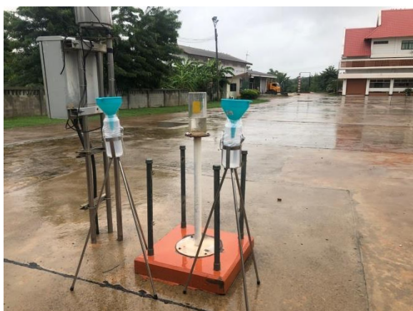
รูปที่ 3-22 การเก็บตัวอย่างน้ำเพื่อวิเคราะห์คุณภาพน้ำฝนแบบสมบูรณ์
