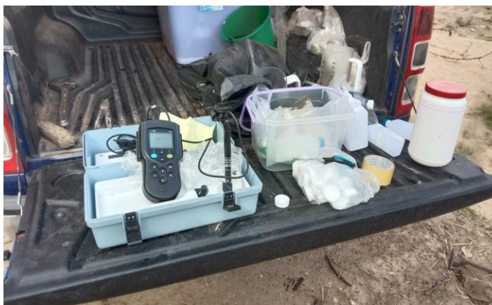
รูปที่ 4-30 การตรวจวิเคราะห์คุณภาพน้ำบาดาลทางเคมีเบื้องต้นตรงบริเวณ ณ ปากบ่อ
