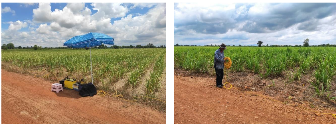
รูปที่ 3-10 การสำรวจธรณีฟิสิกส์โดยวิธีวัดค่าความต้านทานไฟฟ้าแบบสองมิติ
