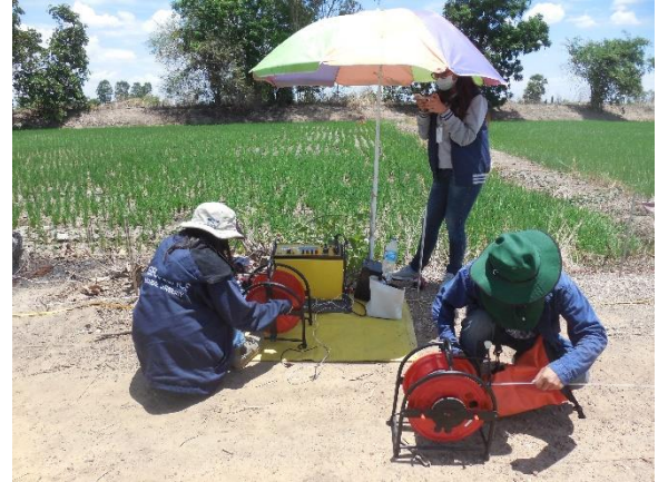
รูปที่ 3-6 การสำรวจธรณีฟิสิกส์โดยวิธีวัดค่าความต้านทานไฟฟ้าแบบหยั่งลึก
