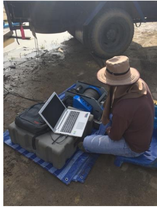
การสำรวจธรณีฟิสิกส์ด้วยเครื่องหยั่งธรณี (Electric Logging)
