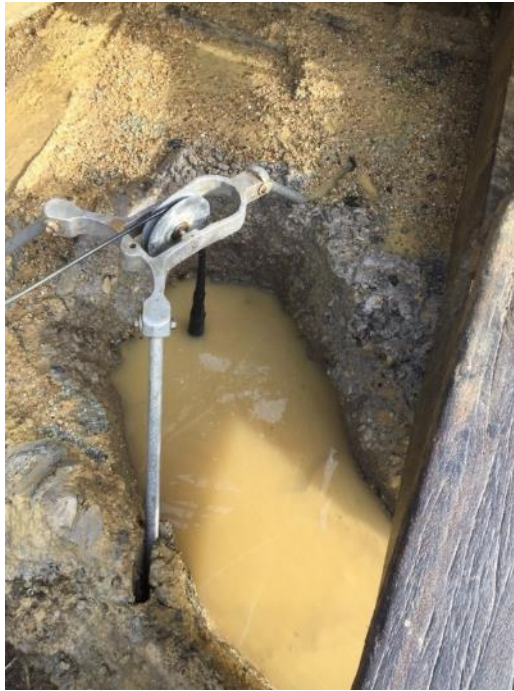
การสำรวจธรณีฟิสิกส์ด้วยเครื่องหยั่งธรณี (Electric Logging)
