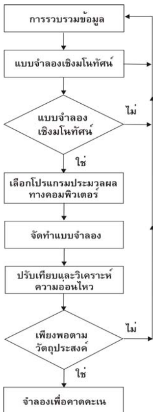
รูปที่ 3-2 กระบวนการจัดทำ แบบจำลองนํ้าบาดาลเชิงคณิตศาสตร์ (ดัดแปลงจาก ASTM D 5880-95, 2004)
