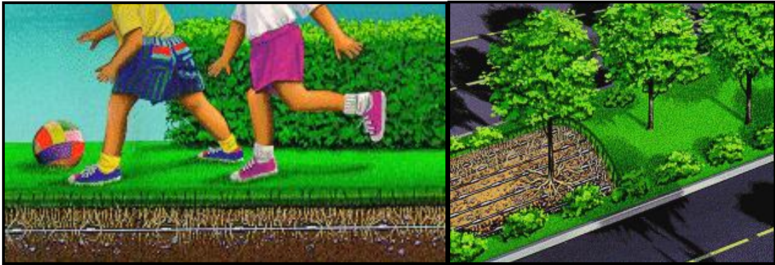
รูปภาพที่ 24 แสดงรูปแบบการชลประทานแบบฝังใต้ดินของประเทศอิสราเอล
