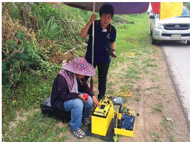
การสำรวจธรณีฟิสิกส์บนผิวดินโดยวิธีวัดค่าความต้านทานไฟฟ้า แบบ 2 มิติ
