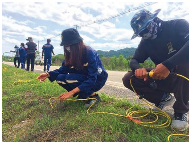
การสำรวจธรณีฟิสิกส์บนผิวดินโดยวิธีวัดค่าความต้านทานไฟฟ้า แบบ 2 มิติ
